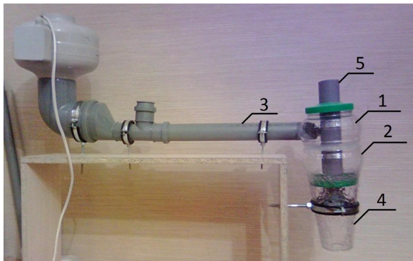
Рис. 1. Экспериментальная установка для исследования способности волокнистых частиц к агломерации в воздушном потоке
