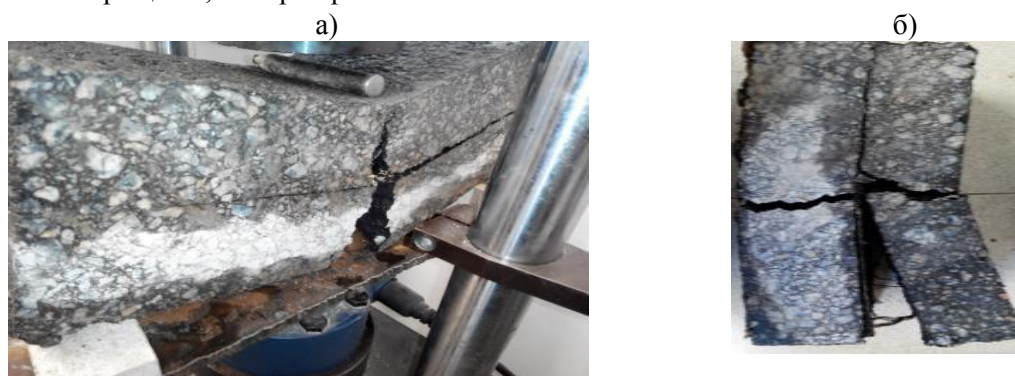
Рис. 2. Вид образца-балочки 120×120×320 мм, серия № 2 (без розлива эмульсии): а) в момент разрушения, б) после полного разрушения образца
