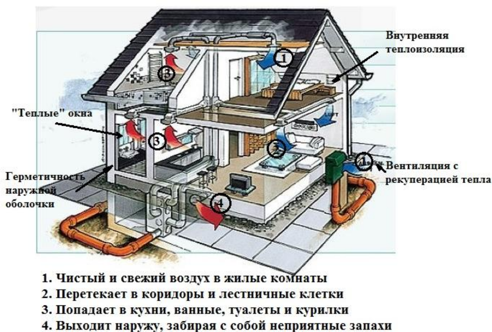
Рис. 4. Организация приточно-вытяжной вентиляции
