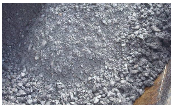
Рис. 6. Гранулометрическая сегрегация смеси при выгрузке
