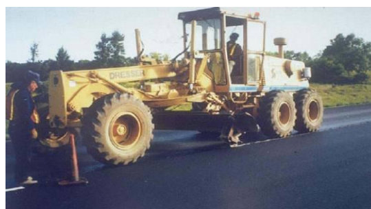
Рис. 12. Установка отрезного диска на автогрейдере
