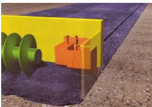
Рис. 9. Схема крепления приспособления для устройства клина
