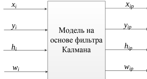
Рис. 5. Схема в виде чёрного ящика математической модели регистрации положения объекта на основе расширенного фильтра Калмана
